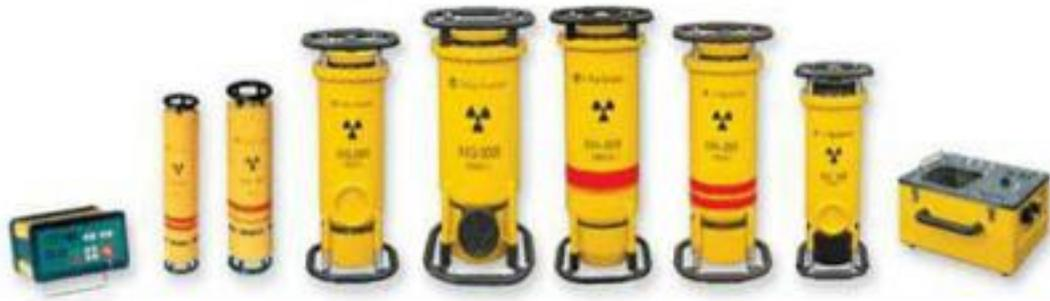
图 9-1 常见 X 射线探伤装置
