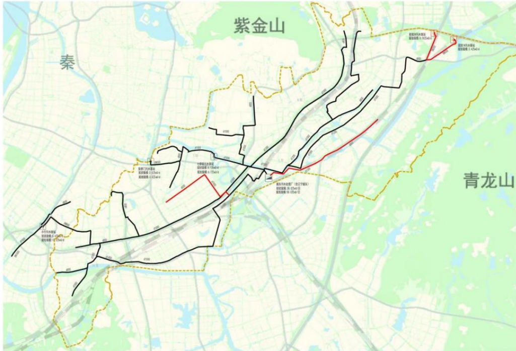
图 2.5.4.1-3 城东污水系统规划图
