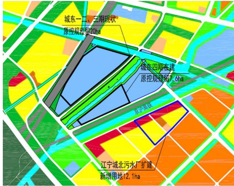
图 2.5.4.1-2 城东污水处理厂用地调整示意图
