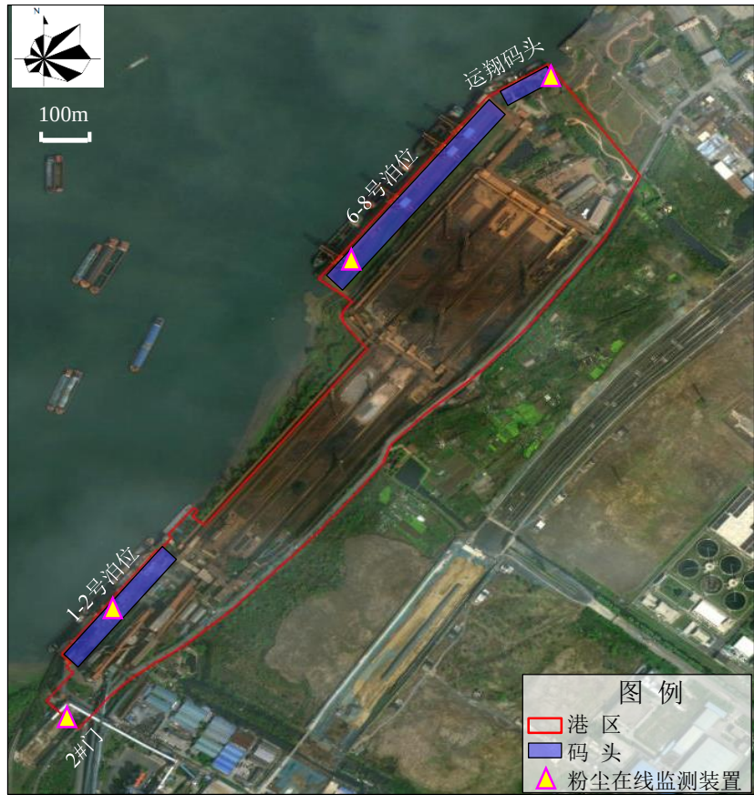
图10.3-1 原料码头港区粉尘在线监测点位分布示意图
