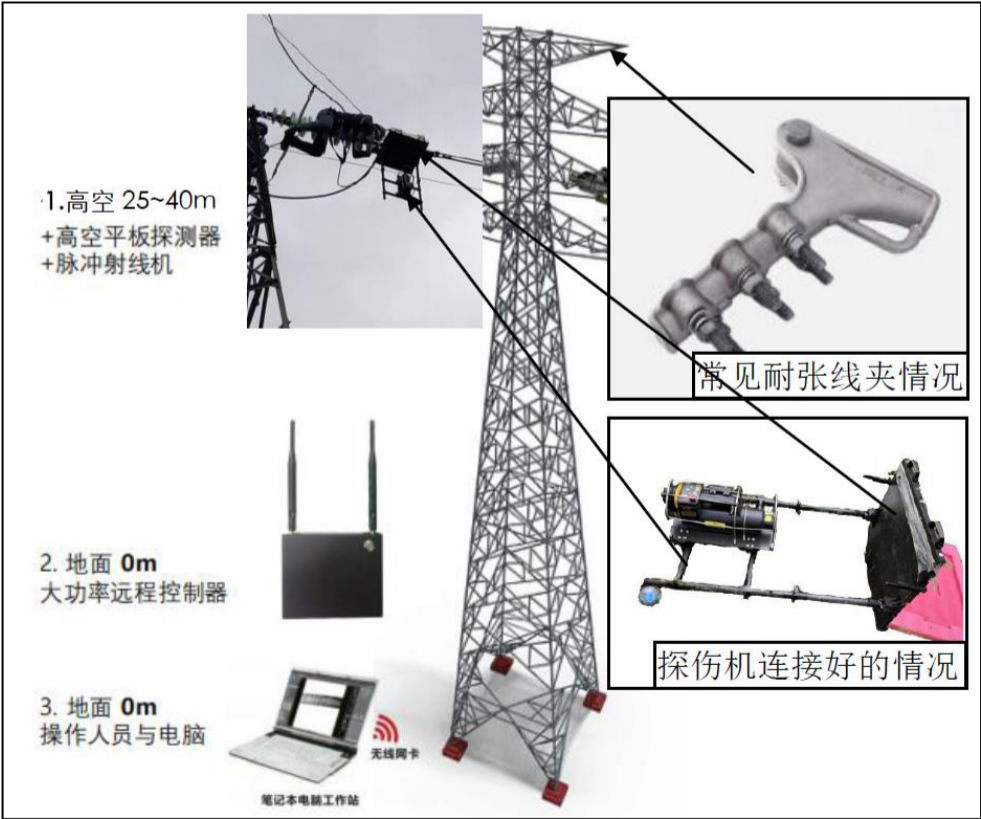
图 9-6 设备组成及使用现场整体框架示意图
