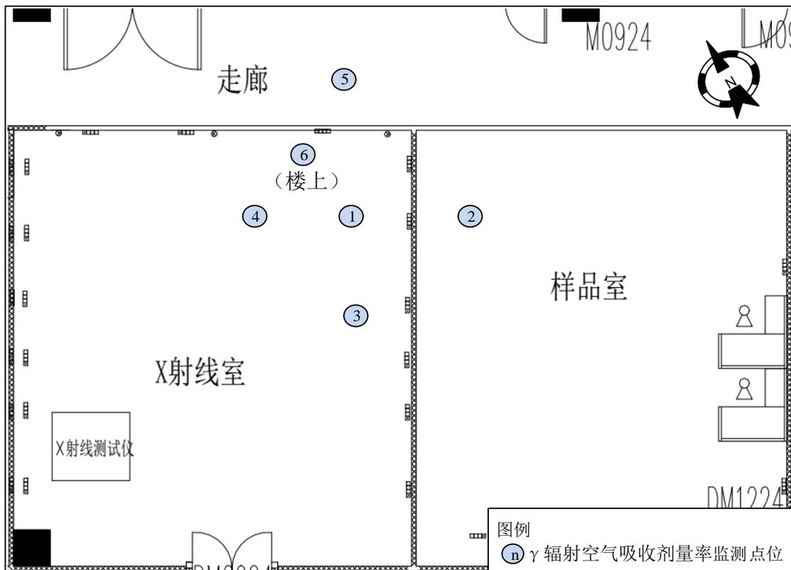
图 8-2 本项目工业 CT 装置拟建址周围环境  $\gamma$  辐射空气吸收剂量率监测点位示意图
