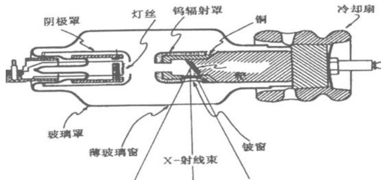
图 9-3 典型的 X 射线管结构图
