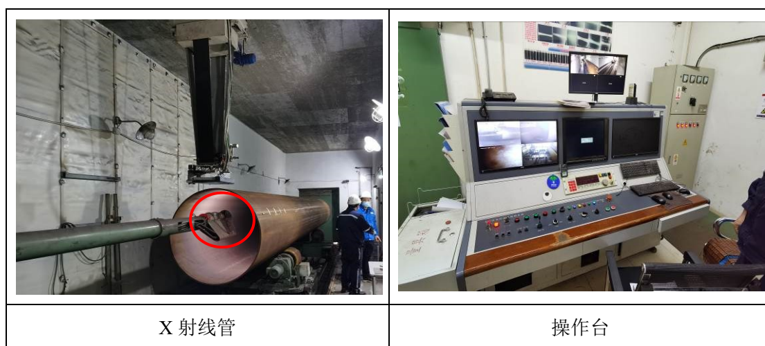
图 9-2 1#探伤房 X 射线实时成像检测系统样式图
