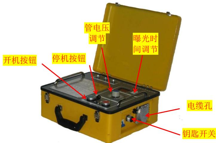
图9-1 常见X射线探伤装置控制台
