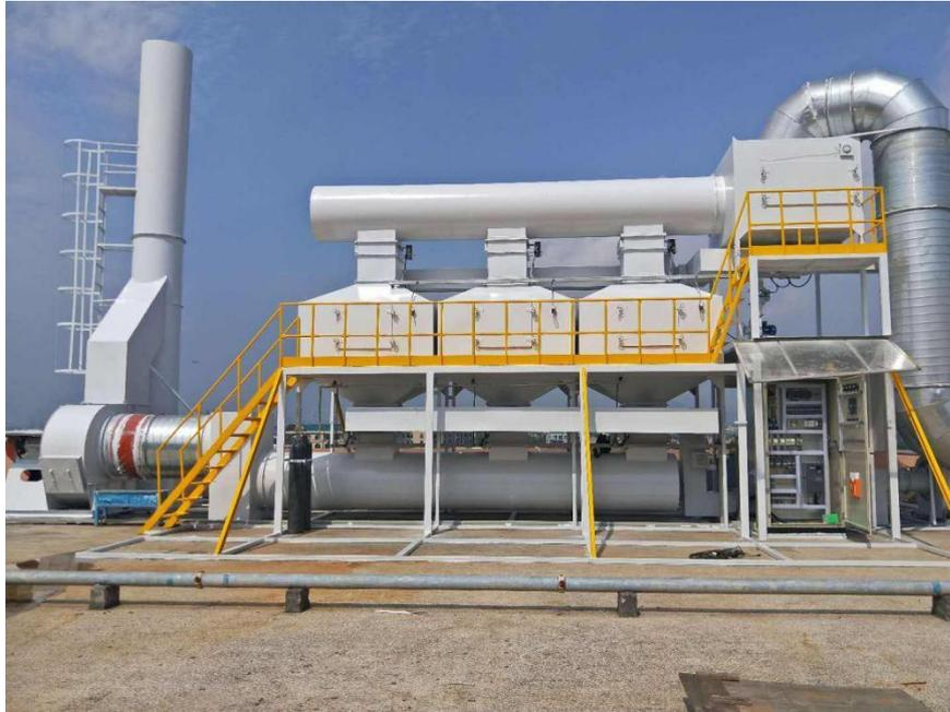
**图 4-2 活性炭吸附脱附催化燃烧装置实例图**
