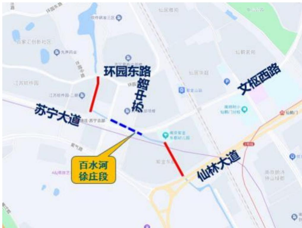
图 2.3-5 百水河徐庄段疏浚段落平面示意图（红线明渠疏浚、蓝线暗涵疏浚）
