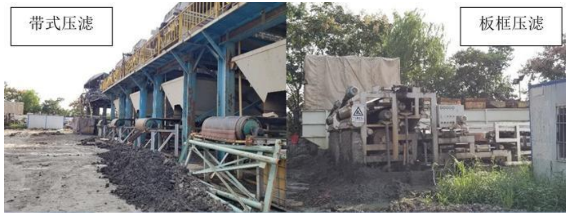
图 3.2-10 机械压滤脱水法示意图
