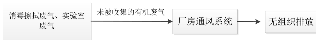
图 4-2 项目无组织废气收集和处理措施流程示意图
