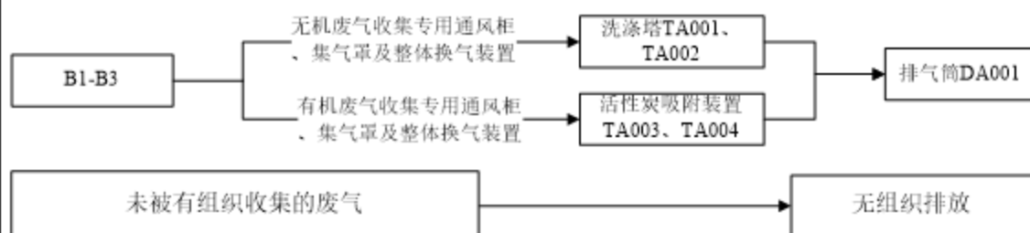
图 4-1 废气处理工艺流程图
