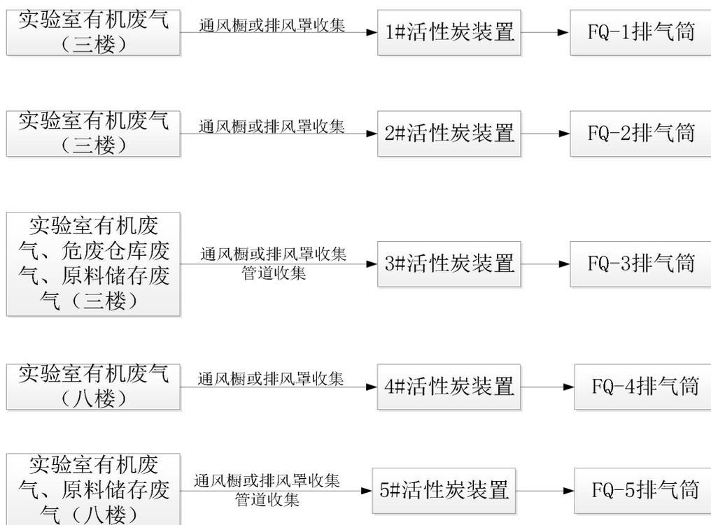
图2-15 现有项目废气收集处理流程图
