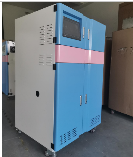
图 4-1 检验化验废水预处理设施照片
