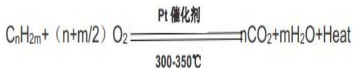
反应释放出大量热量，使气体温度进一步升高（可达 350-450℃）。高温净化气体离开反应室，再次进入换热器。它将自身的热量传递给刚进入的冷废气，自身则被冷却至一个较低的温度（通常只比进气温度高几十度）。此过程回收了反应产生的热量，极大降低了加热器的能耗。
