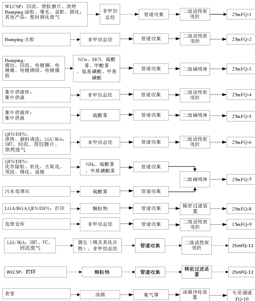
图 2-3-9 废气收集处理工艺示意图
