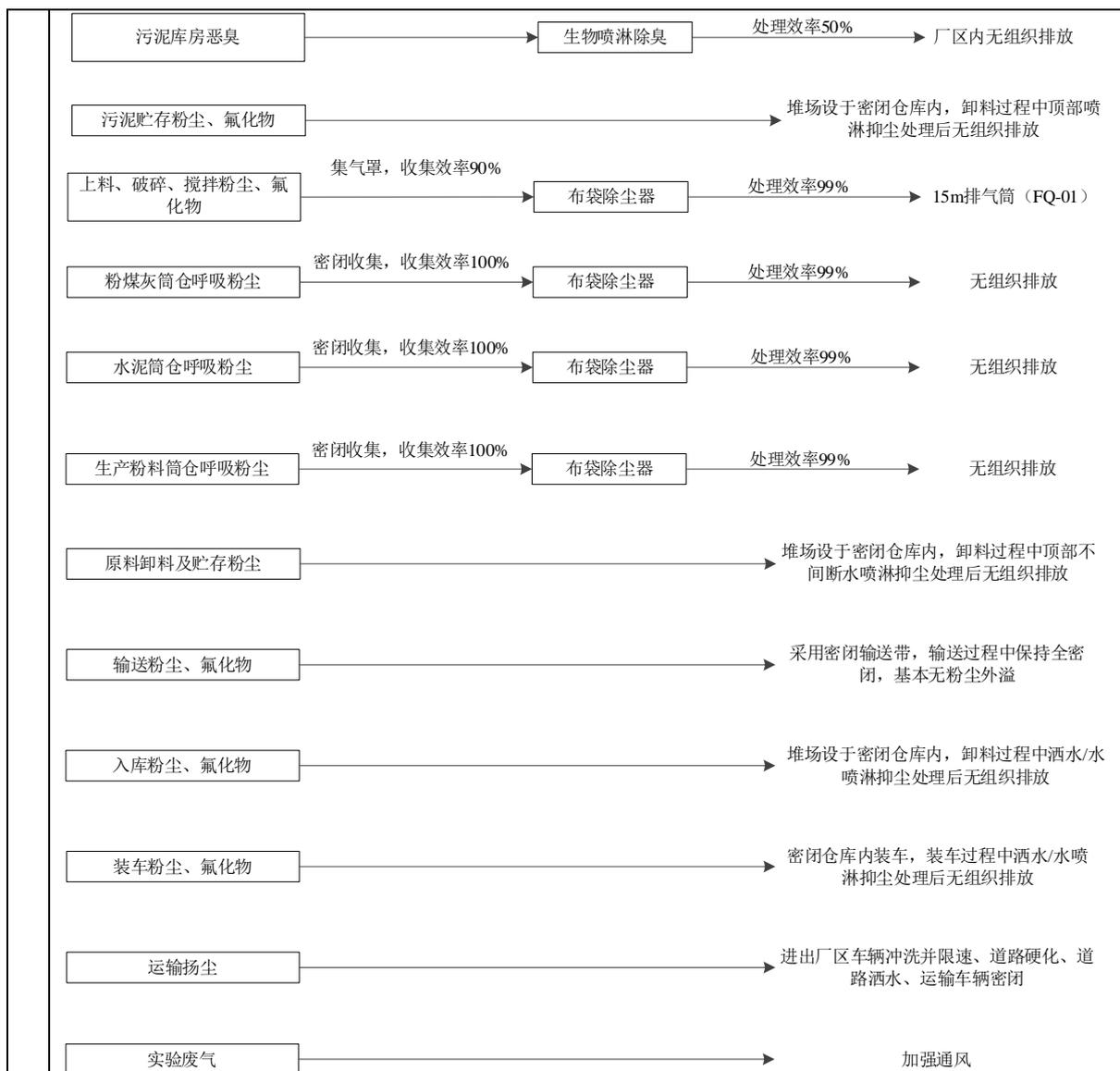
图 4-1 本项目废气收集和治理示意图
