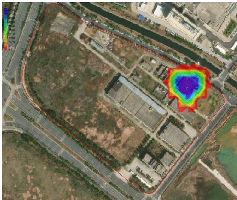
图 6.5-7 非正常工况下综合污水处理站运行 100 天后耗氧量 ( \text{COD}_{\text{Mn}} ) 迁移分布图
