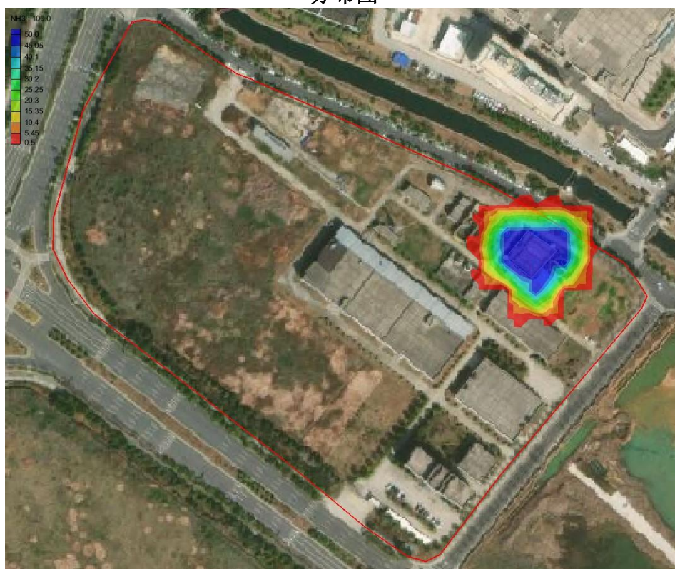
图 6.5-10 非正常工况下综合污水处理站运行 100 天后氨氮迁移分布图
