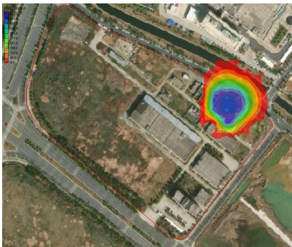
图 6.5-9 非正常工况下综合污水处理站运行 10000 天后耗氧量 (COD Mn ) 迁移分布图
