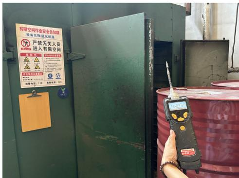
聚氨酯预聚体以罐装形式进入烘箱进行预热，无组织废气产生量较小，VOC现场检测结果为12.59ppm。
