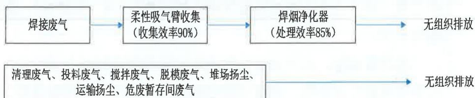
图 2-5 废气收集处理流程图
