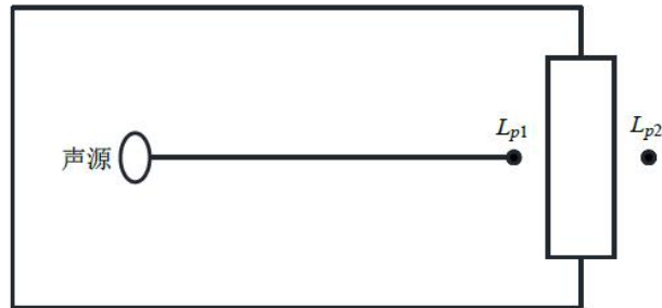
图 4-2 室内声源等效为室外声源图例
