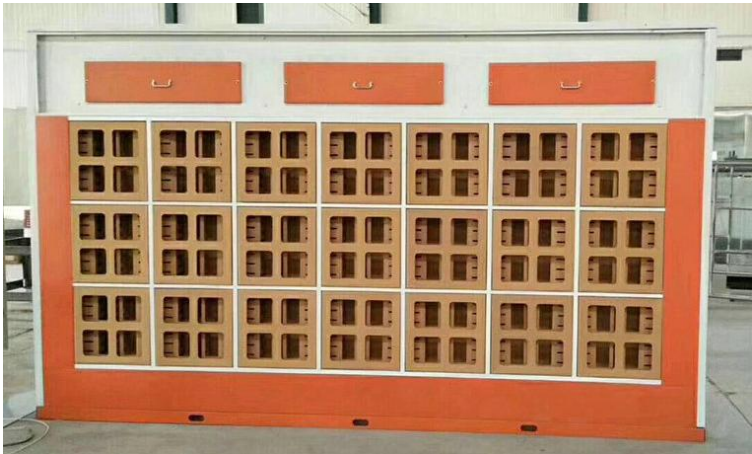
图 4-3 干式漆雾过滤装置示意图
