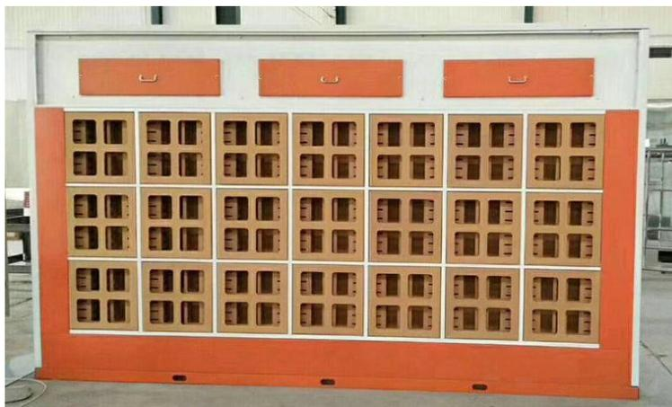
图 4-3 干式漆雾过滤装置示意图
