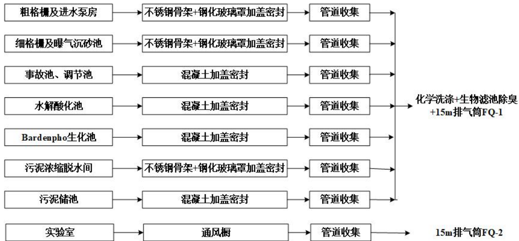
图 6.1-1 有组织废气产生、收集、处理情况示意图
