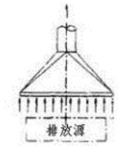
图 4-2 集气罩结构示意图
