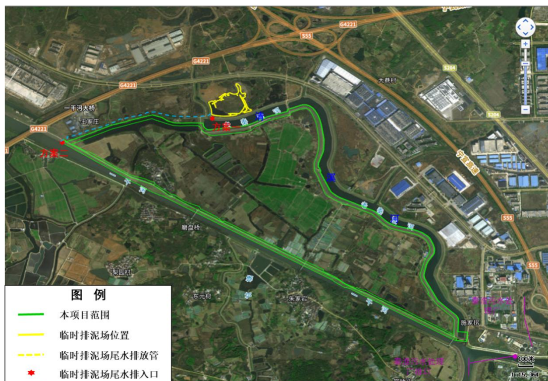
图 7.1-2 临时排泥场尾水排放口方案示意图
