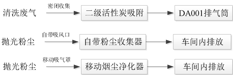
图6 现有项目废气收集处理系统图
