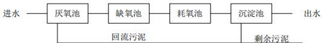
图 4-3 矿业机电产业园污水处理站处理流程图
