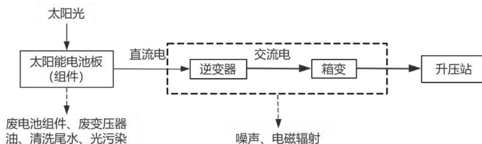
图 4-1 项目运营期工艺流程及排污节点示意图
