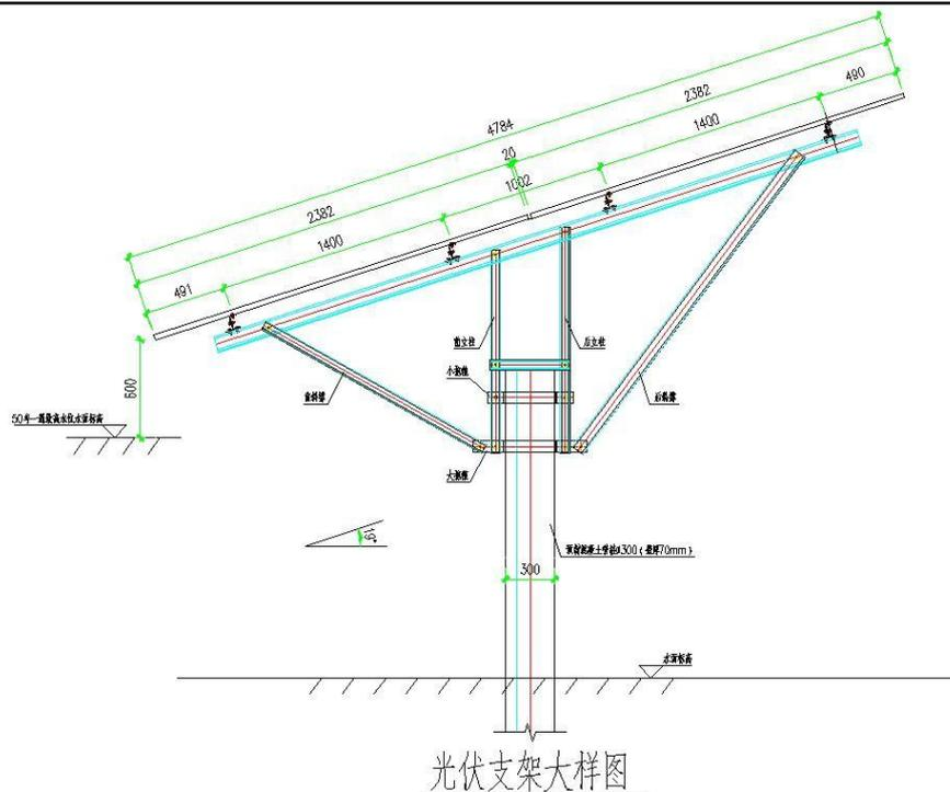
图 2-2 光伏支架基础示意图
