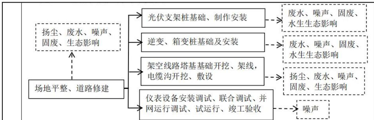
图 2-1 施工工艺流程及产污环节图
