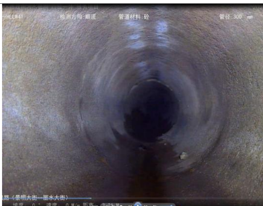
翔凤路与弘利路交汇处雨污水混接支管照片
