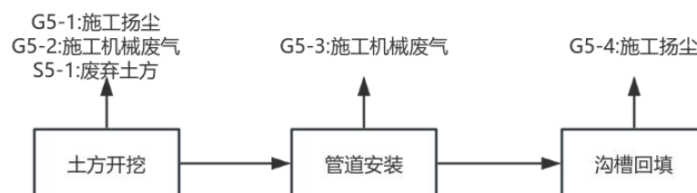
图 2-11 新建再生水管道工程工艺流程图
