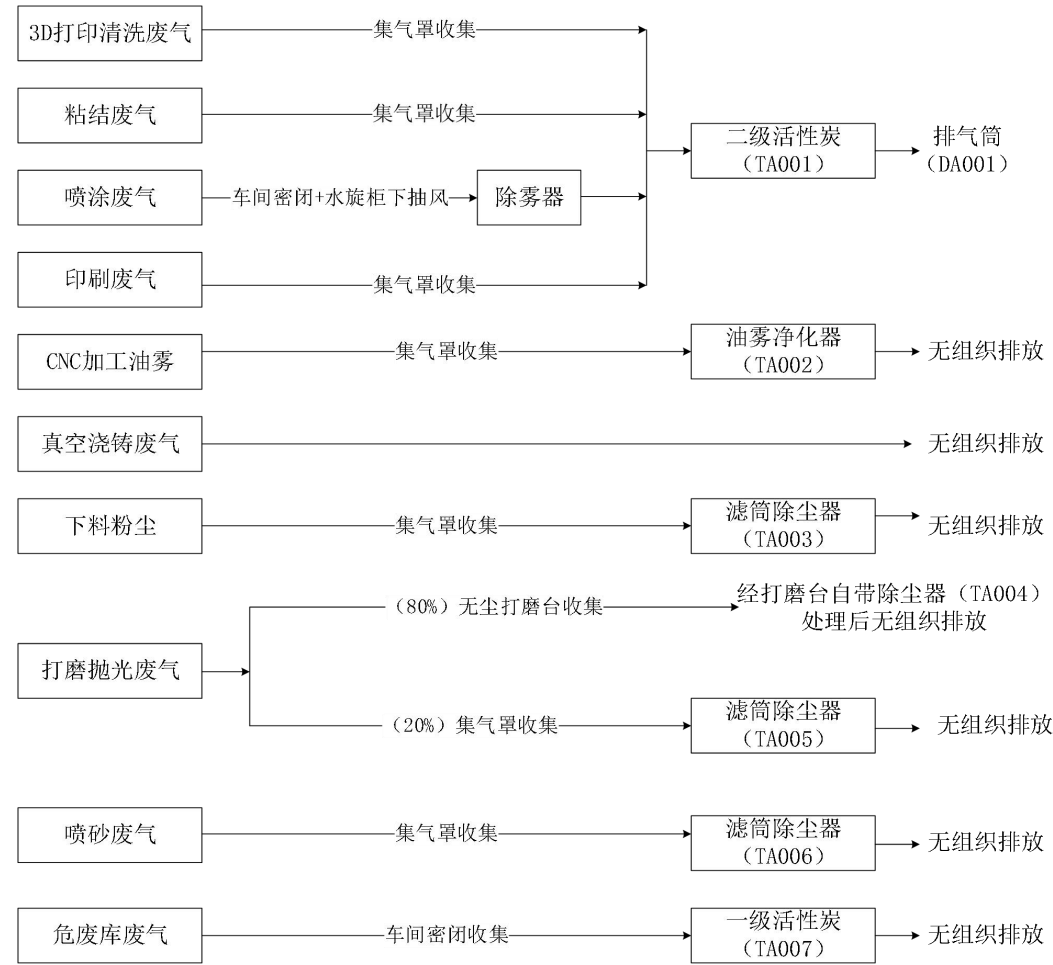
图 4-1 废气收集处理流程图
