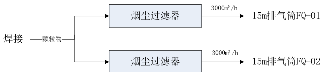
图 2-8 现有项目废气处理工艺流程图
