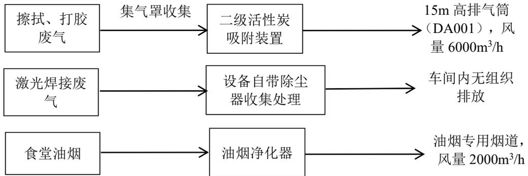
图 4-1 本项目废气治理工艺流程图
