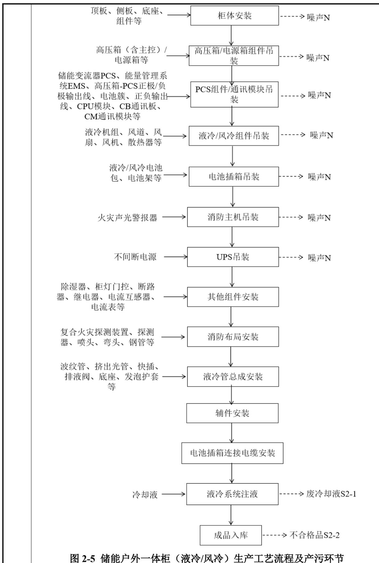
图 2-5 储能户外一体柜（液冷/风冷）生产工艺流程及产污环节
