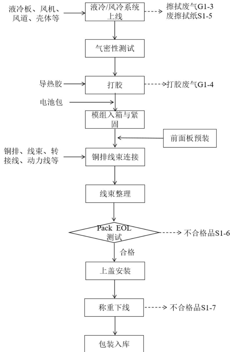
图 2-4 液冷/风冷电池包生产工艺流程及产污环节
