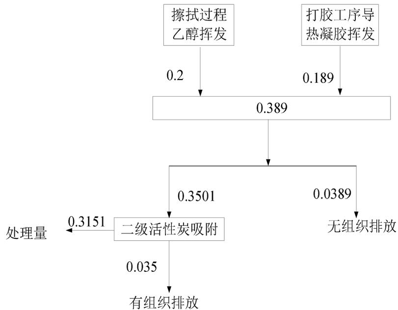
图 2-2 本项目 VOCs 平衡图 单位: t/a
