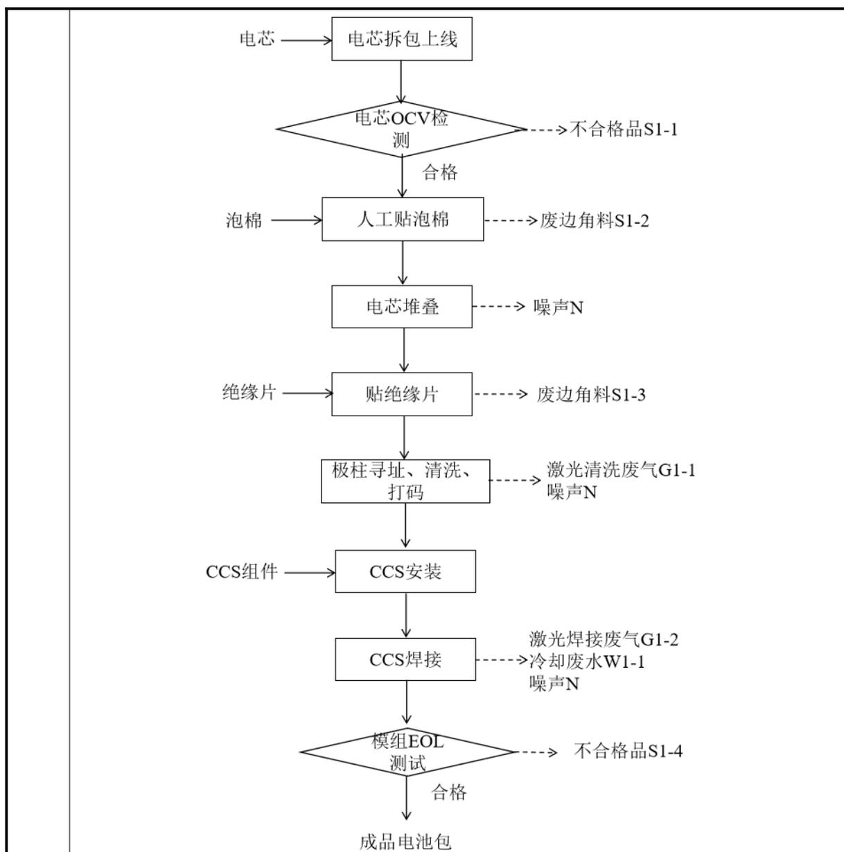
图 2-3 电池包生产工艺流程及产污环节
