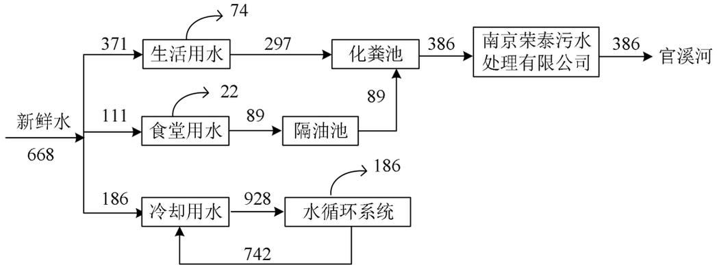
图 2-1 本项目给排水平衡图 (t/a)
