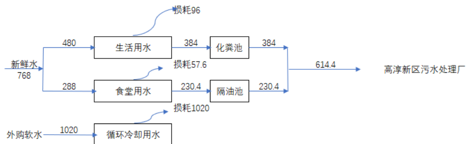
图 2-1 本项目给排水水量平衡图 单位：m 3 /a
