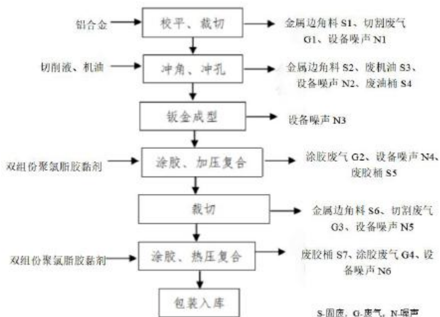
图 2-4 铝板幕墙生产工艺流程图
